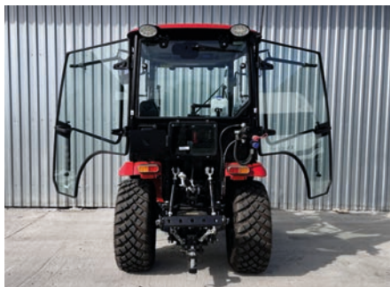
Portes transparentes pour une meilleure visibilité de l'opérateur
